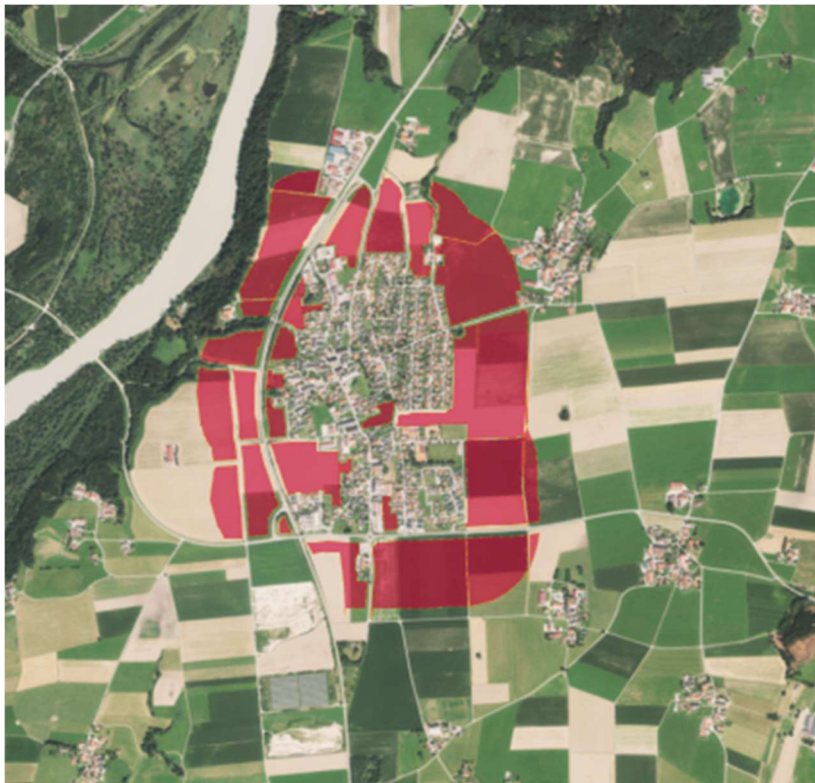
Abbildung 13: potenzielle zentrale Solarthermiefläche mit 300m Abstand zum Eignungsgebiet
