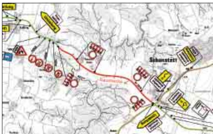
Auf einer Länge von 2,3 Kilometern wird die Fahrbahn von der Einmündung nach Kornau bis zum Kreisverkehr bei Aichet zur Verbesserung der Verkehrssicherheit erneuert und die Fahrbahn von derzeit 5,80 Meter auf 6,50 Meter verbreitert.
